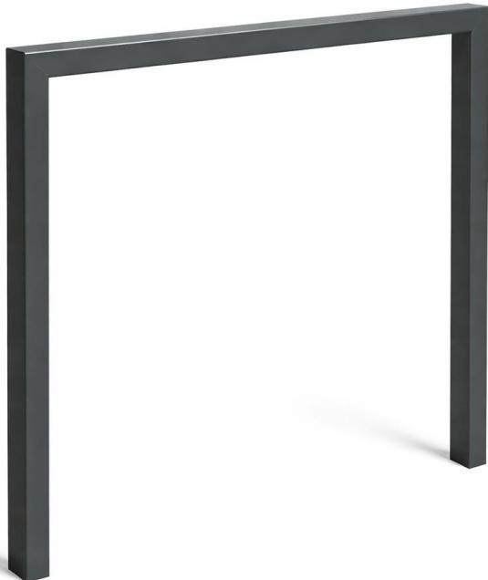
**Le support vélos Défense simple** d'installation et d'utilisation permet de stationner jusqu'à 2 vélos dans les espaces publics et les environnements extérieurs. Scellement sur 25cm. Dosage béton 350kg/m<sup>3</sup> minimum.
